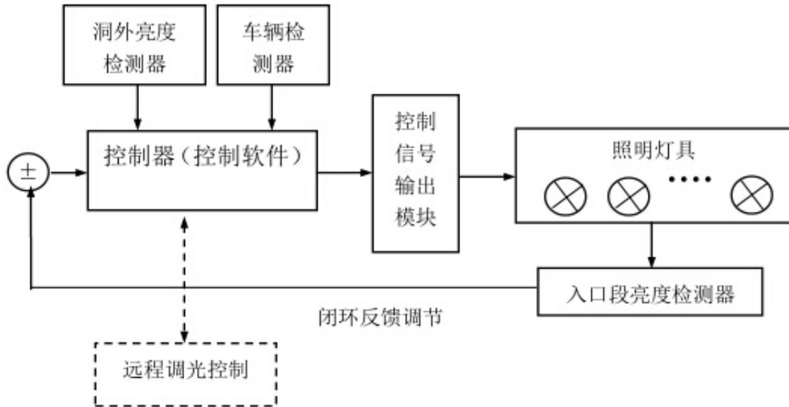
图1 控制系统构成图
