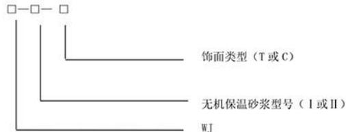
示例 1: WJ—I—C 涂料饰面层 I 型无机保温砂浆墙体保温系统
